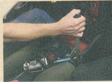
Met zo'n hydraulische handrem - bekend uit de rallysport - gooi je de kont in één ruk om.
